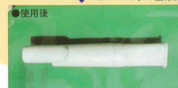
各器材を汚れ（タンパク質）に呈色反応する試験薬「アミドブラック10B」で確認した。（※写真の青色部分が残留する汚染物）
