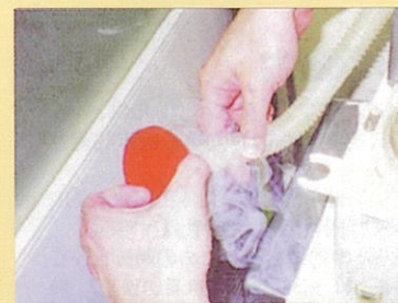
●使用後の超音波ネブライザーより30秒間、寒天培地に直接噴霧する。また、吸気ホース（蛇管）内部を滅菌綿棒によりふき取り、菌の確認を行った。
